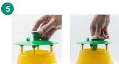
Introduire la cage par le trou qui se trouve au centre du couvercle et appuyer jusqu'à un parfait ajustement.
